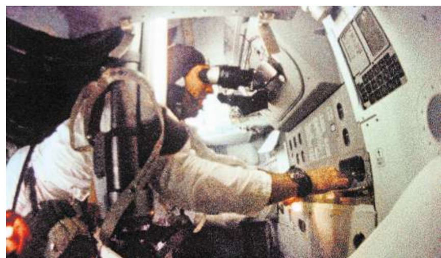
Heerbruggger Gerät im Weltraum: Arbeit an Bord der Apollo 11 mit «Space Sextant» und Objektiv von Wild (16mm-Filmstill). Bild: The Nasa Library/ Alamy Stock
