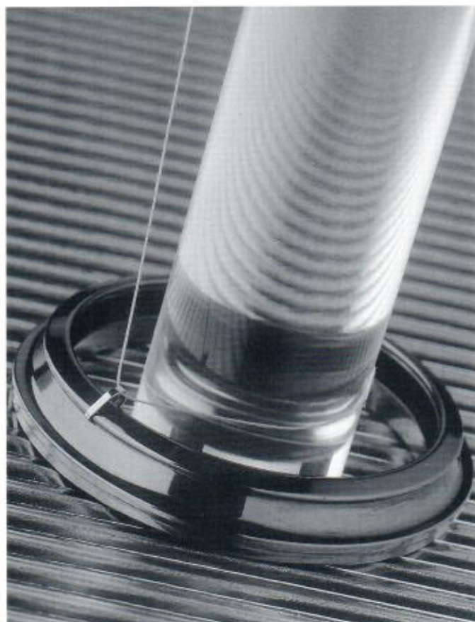
Ring und Läufer des ORBIT-Systems für Hochleistungsring-spinner
