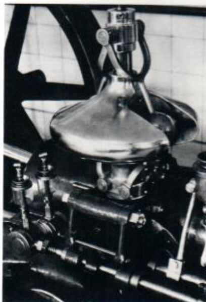
Sulzer-Dampfmaschine mit Bodmer-Steuerung (Detail)
